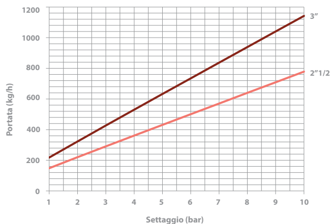
PORTATE DI SCARICO VAPORE - 1811.0-1831.0 2 1/2" - 3"
